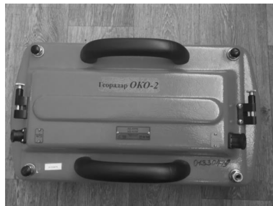
Рисунок 4. – Общий вид георадара ОКО-2
