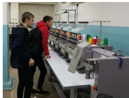
показали разработку конструкции модели одежды в программе «САПР», они увидели как работает дигитайзер — аппарат для распечатки лекал в натуральную величину. Многих ребят удивила работа 12-головочного вышивального полуавтомата.
